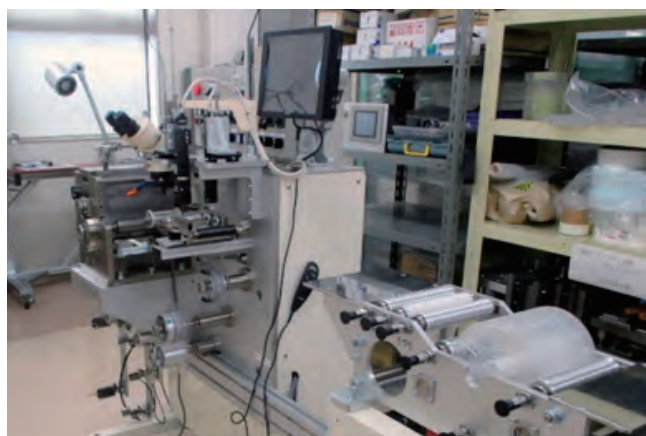
放熱シートなどのゲル状基材をラミネートするために開発された装置
