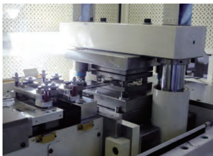
毎分 300 ショット加工な高速ダイニングマシンを 2 台保有し、微細金属部品や容器用の金属／プラ複合材の加工が行われている
