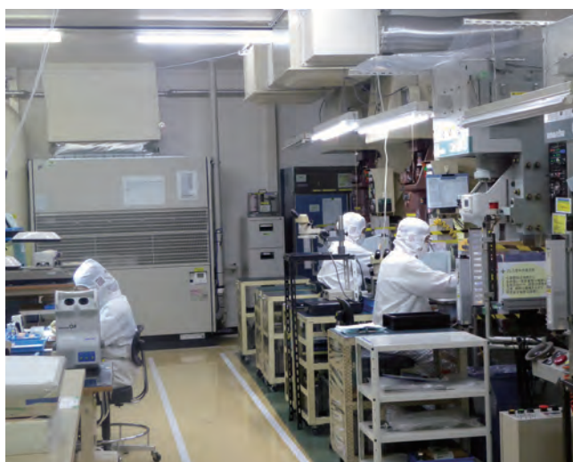
クリーンルーム内で、HEPA フィルターを組み込んだプレス機で抜き加工および検査が行われている
