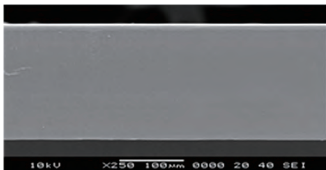
プレス加工したアクリル導光板入光面の SEM 画像
