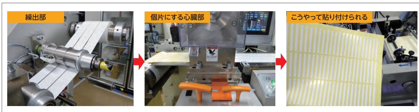
粘着ロール品を巻き出し、多条スリット後、個片にして離型紙に貼り付けるオリジナルライン
