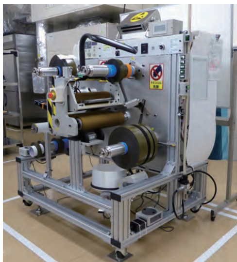
放熱シートなどのゲル状基材をラミネートするために開発された装置
