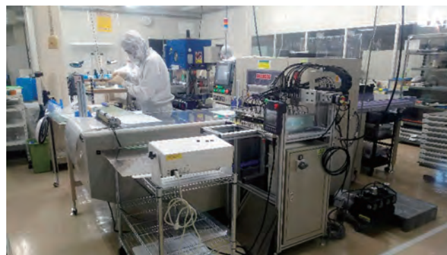
自社開発した IC カードの自動打ち抜き加工装置
